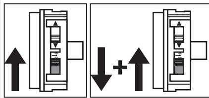
Posuňte rádiový spínač do vnitřní polohy. Pokud se již v této poloze nachází, posuňte spínač do vnější polohy a poté zpět do polohy vnitřní.
