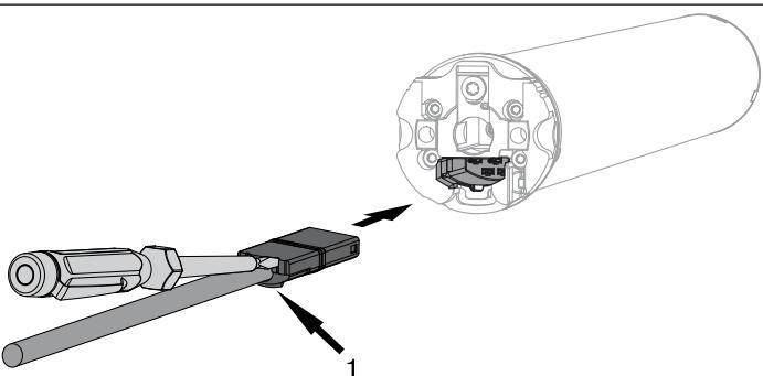
Zasuňte připojovací vedení, **které není pod napětím**, tak daleko do hlavy pohonu, až uslyšíte zapadnutí výstupku pohonu. K dodatečnému posunutí použijte v případě potřeby vhodný plochý šroubovák. Nasadte jej do jedné ze dvou k tomu určených drážek v konektoru.
