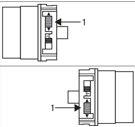
Posuňte přepínač směru otáčení (1) na opačnou stranu.
